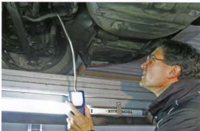
Mit einem elektronischen Gasdetektor werden die Gasleitungen auf Undichtigkeiten geprüft.
