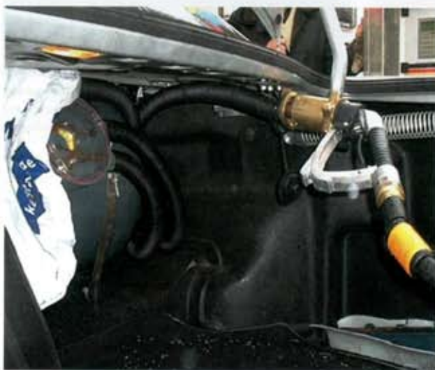
Gruselkabinett der KÜS-Prüfer: Tankanschluss direkt im Kofferraum.
