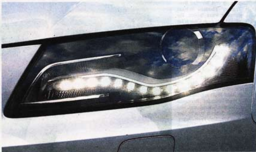
Bei vielen neuen Modellen sind die Tagfahrleuchten schon in die herkömmlichen Scheinwerfer integriert.
