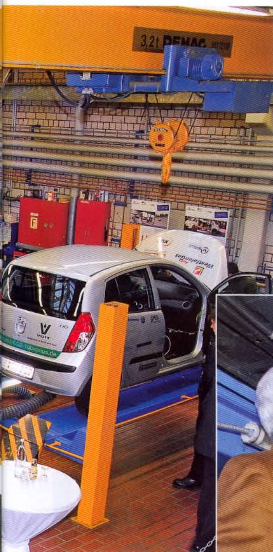
Ungewohnte Perspektive: Prof. Dr. Harald Altjohann (l.) zeigt Vertretern der Sachverständigenorganisation KÜS - die am Projekt CO 2 -100minus beteiligt ist - den Unterboden des Hyundai i10, an dem jetzt kein Benzintank mehr montiert ist.
