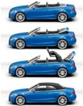
Aufwendiger Mechanismus - um ein Cabriodach wie hier beim Audi S5 zu öffnen oder zu schließen, sind etliche Stellmotoren und Hydraulikzylinder nötig. (Foto: Audi/dpa/tmn)
