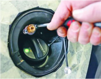
Ein Kfz-Mechaniker montiert einen Einfüllstutzen für Autogas an einen Pkw. Foto: Koch/ddp
