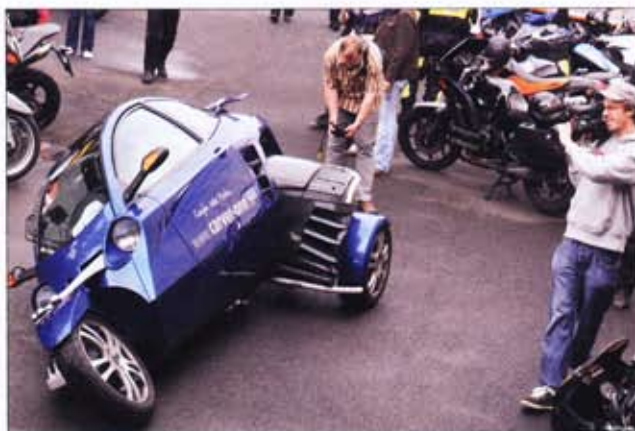
Das „Auto-Motorrad“ Carver vereint das Beste aus zwei Welten. Das futuristische Vehikel kann sich hydraulisch bis zu 45 Grad zur Seite neigen. Carver Deutschland sucht noch Vertriebspartner im Autohandel.
