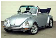
Rekonstruiertes Käfer Cabriolet der Firma Memminger Feine Cabrio: Voll verzinkte Karosserie und spritzverzinkte sowie pulverbeschichtete Bodengruppe
