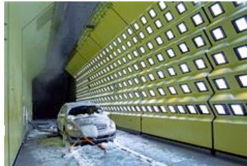
Funktionstest unter Extrembedingungen - bei der Serienerprobung werden Fahrzeug und Klimaanlage im Kältekanal arktischen Temperaturen ausgesetzt. (Foto: dpa)
